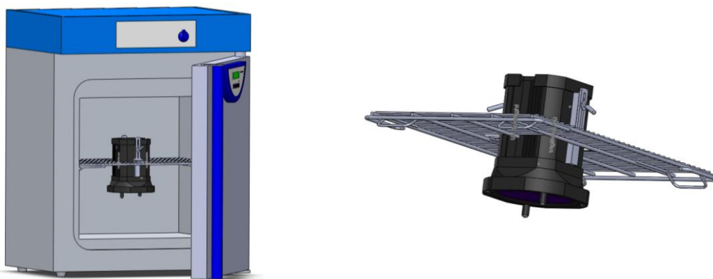
Obrázek 2: Zařízení pro vytvrzování vzorků elektroizolačního laku
